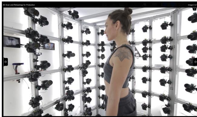
デジカメのAPI活用例。数十台のカメラを同時に制御して3Dモデリングしている。人間では無理。
